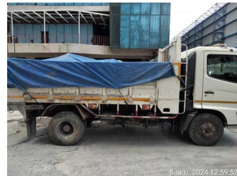
ภาพที่ 2.2-8 การปิดคลุมรถบรรทุก
